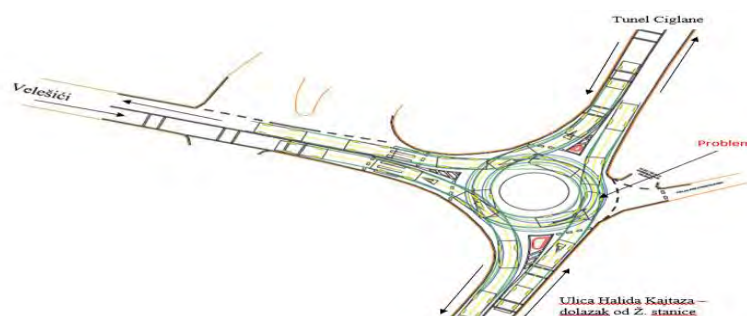
Slika 5. Prikaz konfliktnog mjesta na izgrađenoj kružnoj raskrsnici Dobrinja 34
