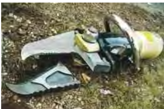
Slika 3. Ojačan stub uzrok pucanja rezača 53
