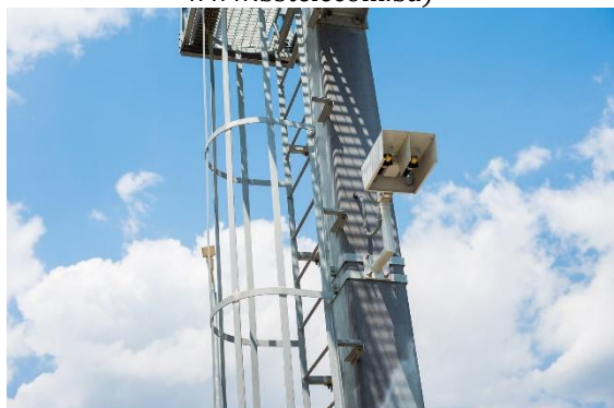
Slika 5. Izgled aktivnog lasera za mjerenje visine vozila (Izvor: www.bstelecom.ba )
